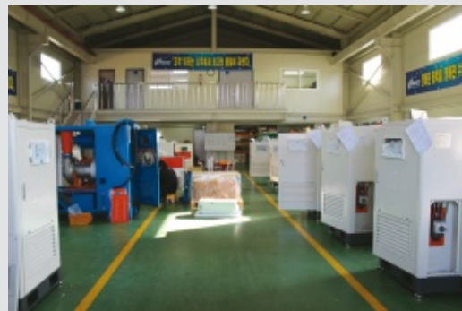
Окончательный монтаж воздуходувок.
